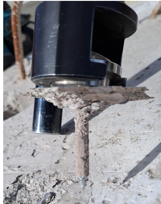
Detalle del procedimiento de ensayo de tracción del sistema de anclaje
