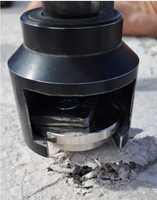
Detalle del procedimiento de ensayo de tracción del sistema de anclaje
